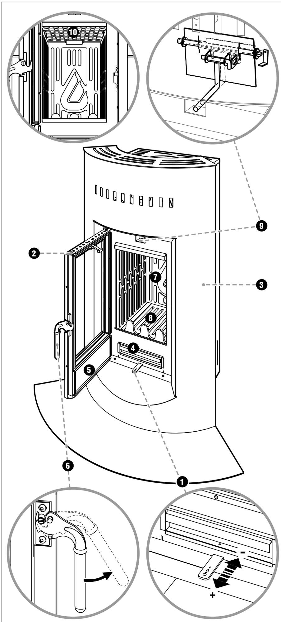
**1) COMANDO ARIA PER LA COMBUSTIONE** (aria primaria): si apre tirando la leva verso l'esterno ed in senso contrario chiude. Anche con il comando chiuso è garantito un flusso d'aria minimo.
